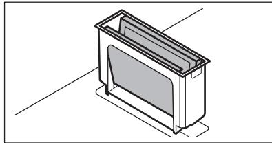
3. Poussez doucement les deux éléments de l'extérieur vers l'intérieur et pliez-les ensemble. Retirez ensuite le filtre du boîtier du filtre.
