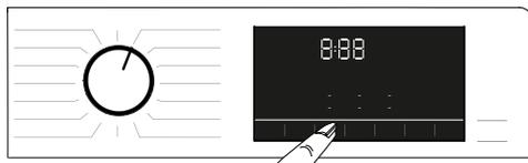
Sélectionnez les fonctions auxiliaires souhaitées avant de lancer le programme. Lorsqu'un programme est sélectionné, les icônes des symboles des fonctions auxiliaires compatibles avec le programme s'allument.
