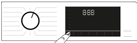
Chaque fois qu'un nouveau programme est sélectionné, la température recommandée pour ledit programme apparaît sur l'indicateur de température. Il est possible que la température recommandée ne soit pas la température maximale pouvant être sélectionnée pour le programme en cours.
