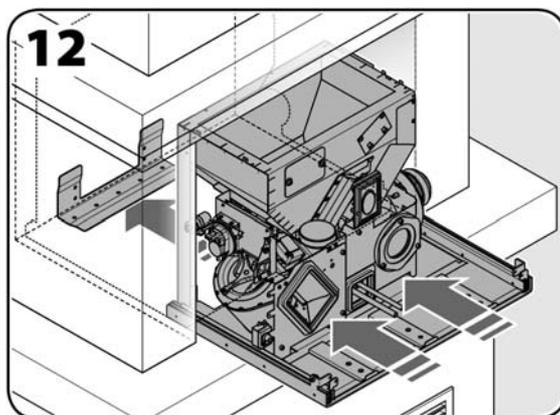
13. Fixer la Base Fixe en utilisant les deux trous situés à l'avant, à la base de l'emplacement. Positionner et fixer la feuille avant (voir paragraphe 2.3.12).
