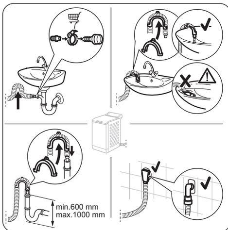
Le tuyau de vidange doit être installé à une hauteur du sol comprise entre 600 et 1 000 mm.
