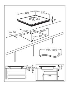
Si l'appareil est installé audessus d'un tiroir, la ventilation de la table de cuisson peut chauffer les éléments rangés dans le tiroir durant la cuisson.
