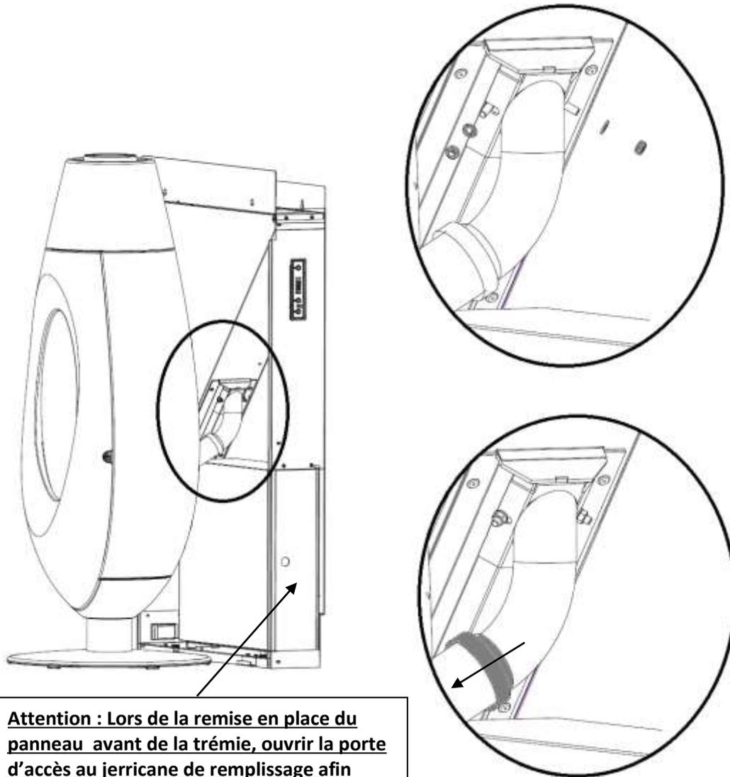
**Attention : Lors de la remise en place du panneau avant de la trémie, ouvrir la porte d'accès au jerricane de remplissage afin d'éviter les rayures sur celle-ci**
