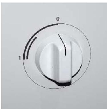
La vitesse de combustion, et de ce fait, le régime de chauffage de la cuisinière dépendent de la quantité d'air de combustion qui arrive sous et à travers la grille du foyer. Ce flux d'air d'admission peut être ajusté par un réglage sans paliers effectué à l'aide du bouton de réglage. Tourner vers la gauche (1) pour augmenter le flux d'air et ainsi la combustion. Tourner vers la droite pour la réduire.
