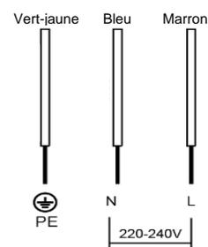
L'installateur doit s'assurer que la connexion électrique est correcte et qu'elle est conforme aux normes locales.
