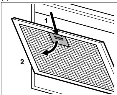
3. Немного наклоните переднюю часть фильтра вниз (2), а затем потянните. Повторите первые два действия с другими фильтрами.
