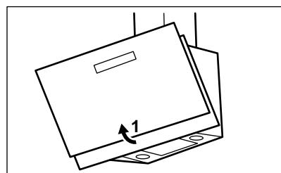
2. Πιέστε τη λαβή του κλιπ στερέωσης στο πλαίσιο του φίλτρου κάτω από τον απορροφητήρα (1).
