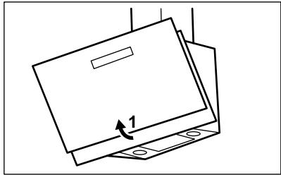
2. Притисните ручку затеге за монтажу на панелу филтера испод аспираатора (1).
