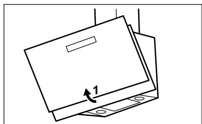
2. Натиснете дръжката на скобата за монтаж върху панела на филтъра под абсорбатора (1).
