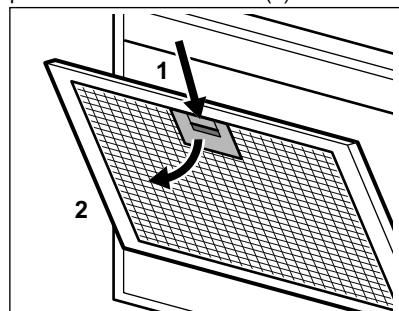
3. Înclinați ușor partea frontală a filtrului în jos (2), după care trageți. Repetați primii doi pași pentru toate filtrele.
