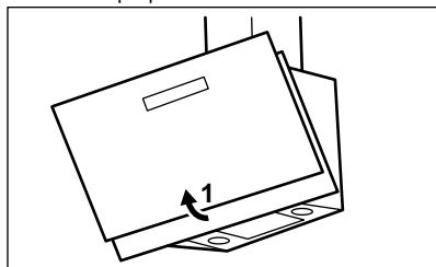
2. Prima o manípulo da mola de fixação no painel do filtro, na parte inferior do exaustor (1).
