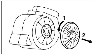
Při instalaci filtrů zpět provedte stejný postup v opačném pořadí.
