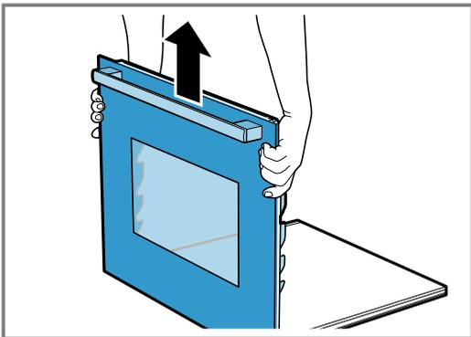
3. Déposez-la avec précaution sur une surface plane. Des composants sensibles se trouvent sur le dessous de la porte de l'appareil.
