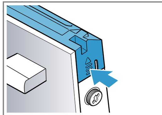
3. Retirez le recouvrement de porte et fermez la porte de l'appareil avec précaution.
