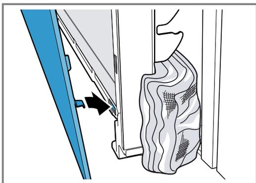
6. Fermez la vitre frontale jusqu'à ce que les crochets supérieurs se trouvent en face de l'ouverture.
