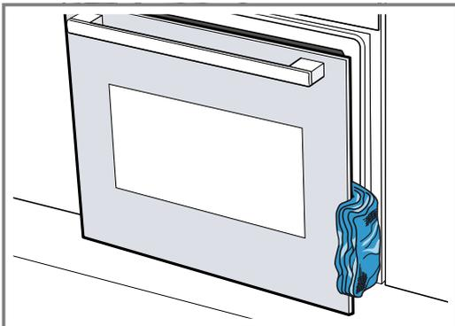
2. Dévissez les vis à gauche et à droite sur la porte de l'appareil et retirez-les.
