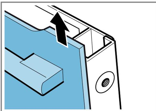
4. Déposez la vitre de la porte une surface plane, la poignée de porte orientée vers le bas.
