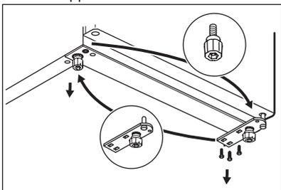
11. Placez la porte dans sa nouvelle position, en vous assurant que la goupille pénètre dans le coussinet de la section inférieure du cadre.
