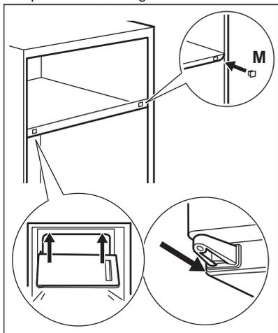
3. Soulevez légèrement la porte du compartiment du congélateur, installez-la dans le support supérieur de la porte et, en même temps, insérez le support inférieur de la porte dans l'orifice carré.
