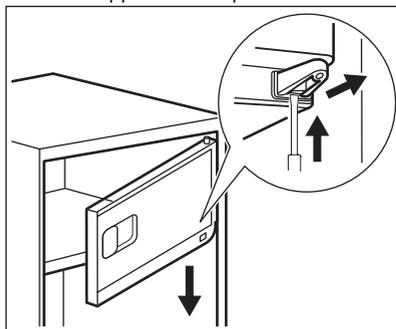
2. Inversez le sens d'ouverture de la porte du compartiment du congélateur à 180° et installez le support inférieur de la porte dans la cavité correspondante de la porte du
