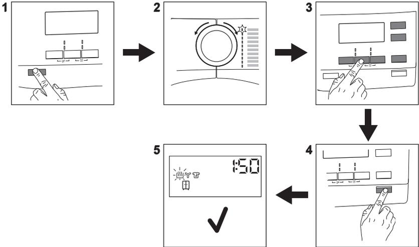
1. Appuyez sur la touche **Marche/Arrêt** pour mettre en fonctionnement l'appareil.
