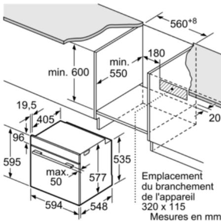
Si l'appareil est installé sous une table
