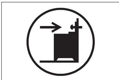
1. Installez la protection anti-basculer 305 - 310 mm en dessous de la surface supérieure de l'appareil et de 80 à 85 mm du côté de l'appareil, dans l'orifice circulaire situé sur un support. Vissez-le dans un matériau solide ou utilisez un renfort adapté (mur).
